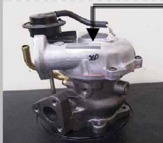
取り外したコアを吸入側から覗いて下さい、シャフトの先端にインペラ締付のナットが付いているはずです。
